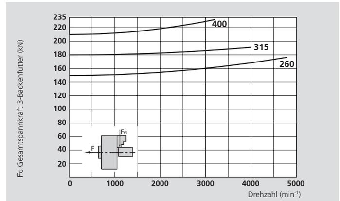
Die Daten in den Diagrammen beziehen sich auf 3-Backenfutter, die nach Bedienungsanleitung frisch gewartet und mit SMW-AUTOBLOK-Fett K67 geschmiert sind. Die statischen und dynamischen Spannkraften sind mit weichen Standard-Aufsatzbacken gemessen, die nicht radial über den Futterkörper überstehen.
