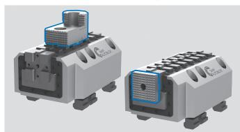
Der Klauenkasten kann mit Standard harten oder weichen Aufsatzbacken auf der Oberseite ausgerüstet werden. Ebenfalls lassen sich spezielle Spanneinsätze auf die Stirnseite aufsetzten. Diese Montageart eliminiert jegliche Hebelwirkung auf die Grundbacke, da der Spannpunkt exakt in der Radialachse der Grundbacke liegt, und bietet somit eine sehr stabile und genaue Spannung. Auch wird dadurch die Aufbauhöhe verringert, was mit konventionellen Aufsatzbacken nicht möglich ist.
