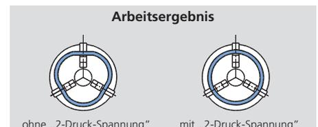
Das Ergebnis sind runde, verformungsarme Werkstücke. Der Absenkyklus wird programmiert und ist in ca. 2–4 Sekunden komplett abgeschlossen.
