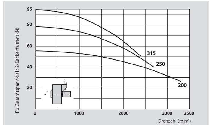
Die Daten in den Diagrammen beziehen sich auf 2-Backenfutter, die nach Bedienungsanleitung frisch gewartet und mit SMW-AUTOBLOK-Fett K67 geschmiert sind. Die statischen und dynamischen Spannkraften sind mit weichen Standard-Aufsatzbacken gemessen, die nicht radial über den Futterkörper überstehen.
